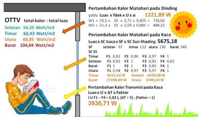
**Gambar 14.** OTTV Facade Selatan untuk Berbagai Orientasi dengan Beton pada Double Skin Dihilangkan
